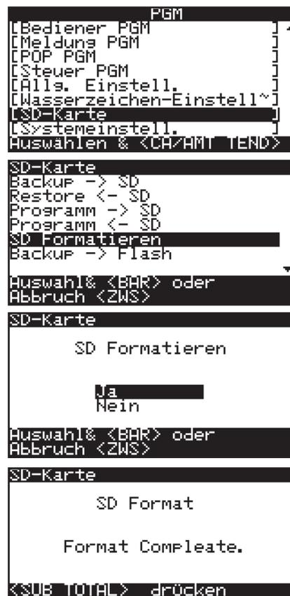
Betätigen Sie die Taste [↓] bis zum Menüpunkt „SD-Karte“ und drücken die Taste <CA/AMT TEND>, dann wieder die Taste [↓] bis zum Menüpunkt „SD Formatieren“ und danach die Taste <CA/AMT TEND>. Abbruch mit der Taste <SBTL>. Im nächsten Fenster drücken Sie die Taste <CA/AMT TEND> um „Ja“ zu bestätigen. Abbruch mit der Taste <SBTL>.
